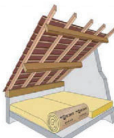
Isolamento sul solaio
